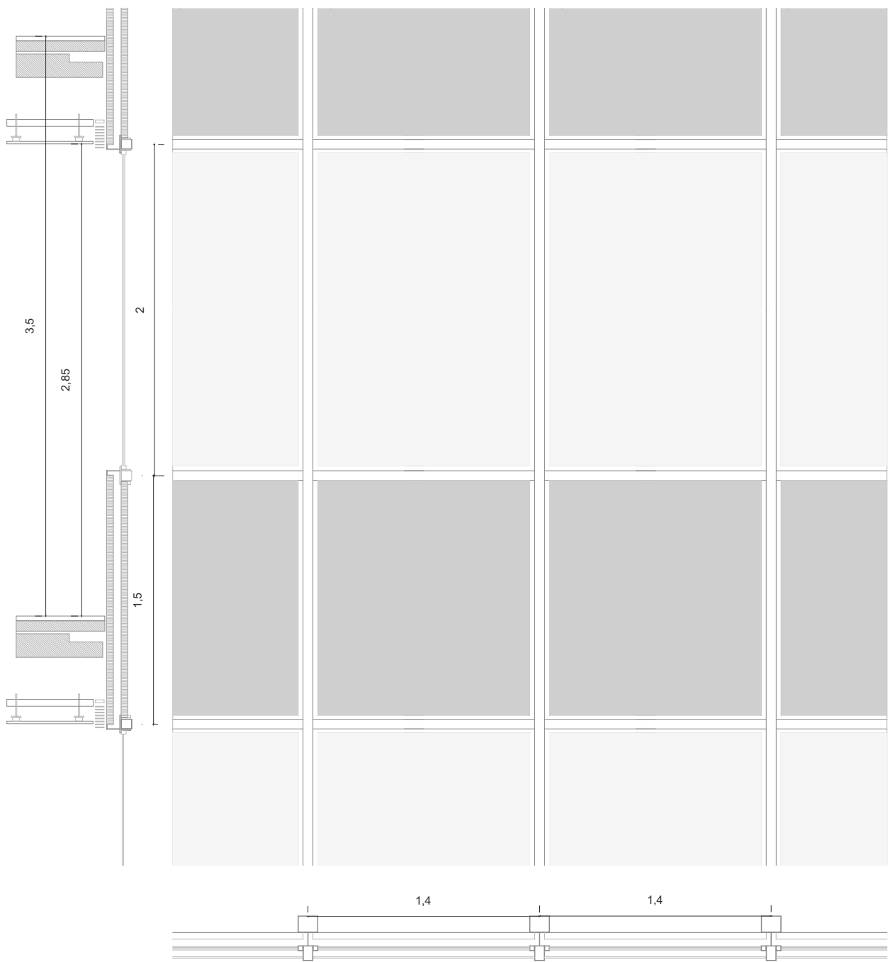
121. Muro cortina Thyssenhaus
